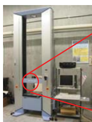
万能試験機 AG-I 20kN
